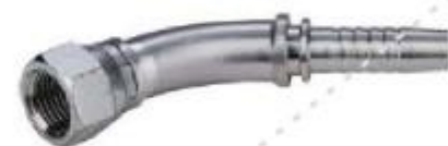
45° 美制JIC内螺纹74° 内锥面 45° JIC FEMALE 74° CONE SEAT SAE J514
